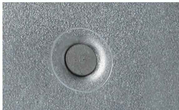
РЕЗУЛЬТАТ УСТАНОВКИ САМОПРОНИКАЮЩЕЙ ЗАКЛЕПКИ
