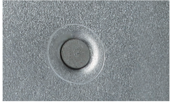
RESULTADO AL PONER UN REMACHE AUTOPERFORANTE
