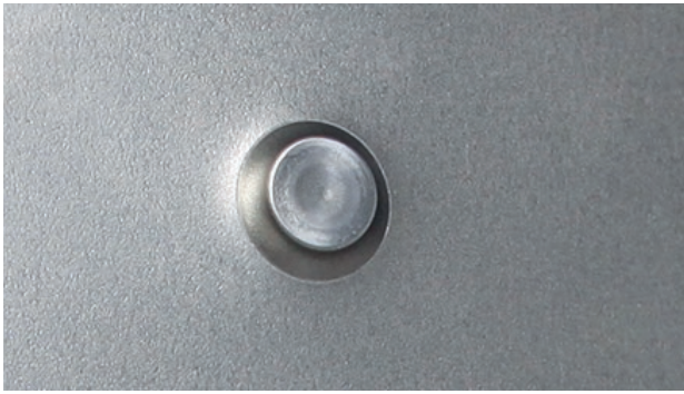
AFBEELDING PONSNAGEL VERBINDING VOOR- EN ACHTER-ZIJDE
