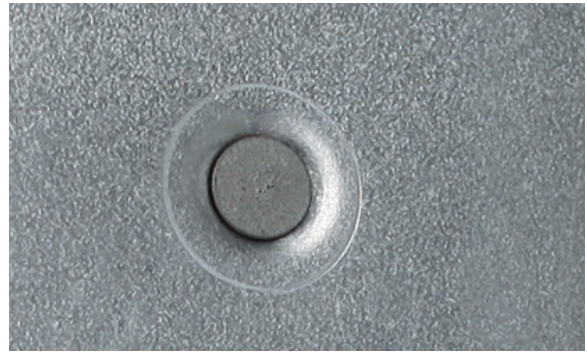
RÉSULTAT DE POSE D'UN RIVET AUTO-PERÇANT
