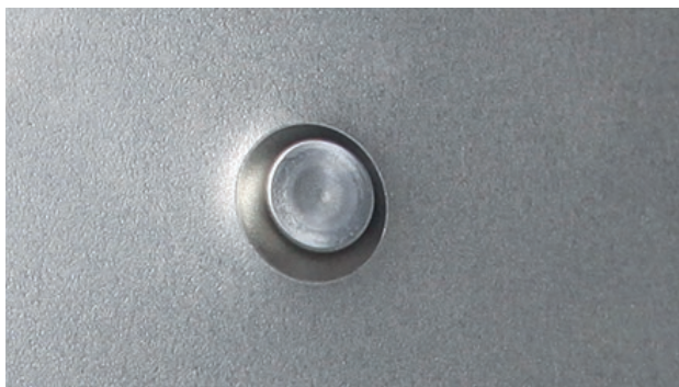
РЕЗУЛЬТАТ УСТАНОВКИ САМОПРОНИКАЮЩЕЙ ЗАКЛЕПКИ
