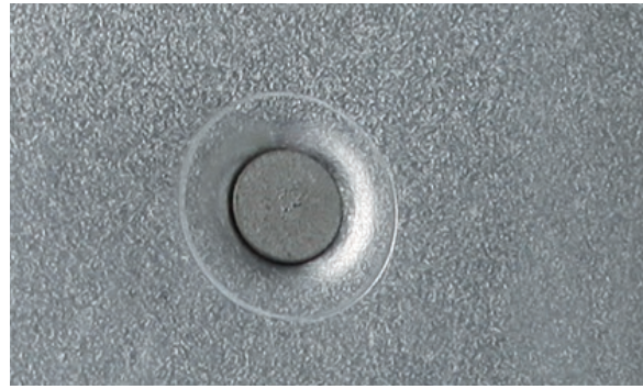
ABBILDUNG STANZNIETVERBINDUNG VORDER- U. RÜCKSEITE
