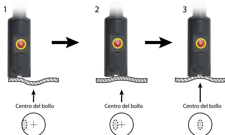
In certi casi, la profondità del bollo aumenterà di taglia durante il riscaldamento (la lamiera si sfonda sull'effetto del riscaldamento). Se questo succede, aumentare il perimetro del riscaldamento intorno al bollo fino a che il bollo non cominci a diminuire di taglia. Per i bolli profondi, riscaldare effettuando movimenti circolari intorno al bollo venendo progressivamente verso il centro.
