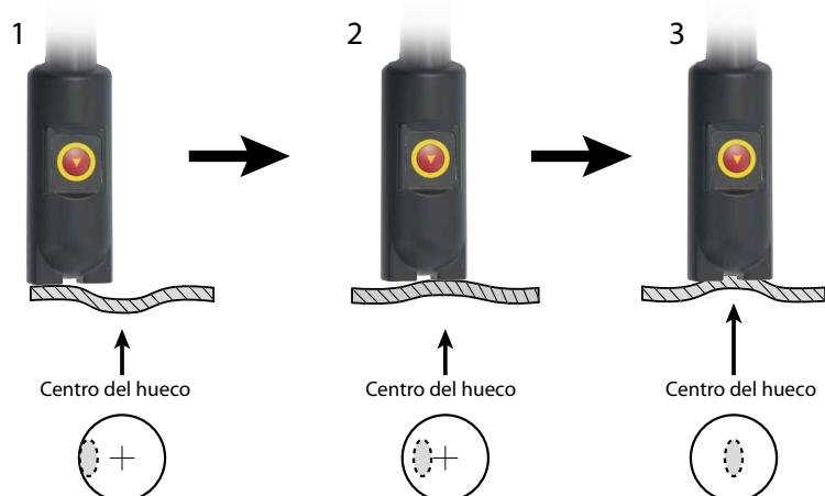
En algunos casos, la profundidad de la abolladura aumenta de tamaño durante el calentamiento (la chapa se hunde por el efecto del calentamiento). Si esto se produce, aumente el perímetro de calentamiento alrededor de la abolladura y continúe calentando hasta que la abolladura comience a disminuir. Las abolladuras profundas requieren calentar de manera circular alrededor de estas para llegar al centro.
