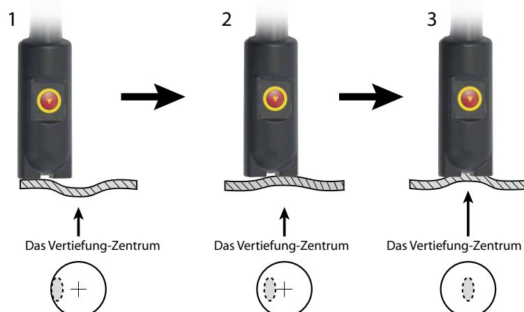
In manchen Fällen vergrößert sich die Beule während des Heizvorgangs (das Karosserieteil fällt unter der Wirkung der Hitze ein). Wenn dies geschieht, bearbeiten Sie einen größeren Bereich um die Beule herum und erhitzen Sie weiter bis die Beule kleiner wird. Bei tiefen Beulen den Bereich um die Beule herum von außen nach innen kreisförmig erhitzen.
