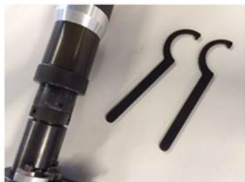
Les 2 clés fournies permettent d'ajuster la hauteur du poinçon. Pour augmenter la hauteur du poinçon, pour laisser passer un graton à l'extrémité de l'anneau, il faut dévisser la partie supérieure. Ajuster la hauteur du poinçon. Puis, bloquer ensuite l'ensemble à l'aide de la bague inférieure, avec les 2 clés fournies.
