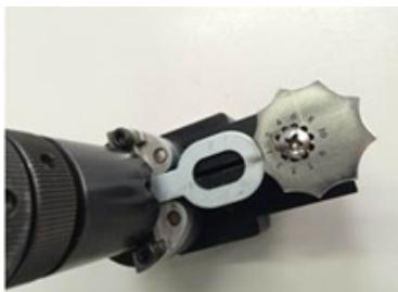
La partie arrière des anneaux de tirage doit venir en contact avec la roue dentée, comme montré sur la photo ci-contre. Les nombres sur la roue dentée correspondent à la longueur de découpe des anneaux. Pour le 1<sup>er</sup> affutage, placer la roue sur la position 1. Progressivement, pour les affutages suivants, augmenter le nombre sur la roue dentée pour augmenter la longueur de coupe des anneaux. Plus le nombre est élevé, plus la longueur de l'anneau sera réduite.
