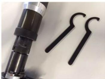
Le 2 chiavi fornite permettono di adattare l'altezza del punzone. Per aumentare l'altezza del punzone, per lasciar passare un anello con un eventuale rigonfiamento all'estremità, bisogna svitare la parte superiore. Regolare l'altezza del punzone. Poi bloccare l'insieme con l'aiuto dell'anello inferiore, con le 2 chiavi fornite.
