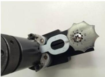
La parte posteriore degli anelli da trazione dev'essere in contatto con la ruota dentata, come mostrato sulla foto qui di seguito. I numeri sulla ruota dentata corrispondono alla lunghezza del taglio degli anelli. Per la 1a affilatura, posizionare la ruota sulla posizione 1. Progressivamente, per le affilature seguenti, aumentare il numero sulla ruota dentata per aumentare la lunghezza del taglio degli anelli. Più il numero è elevato più la lunghezza dell'anello sarà ridotta.
